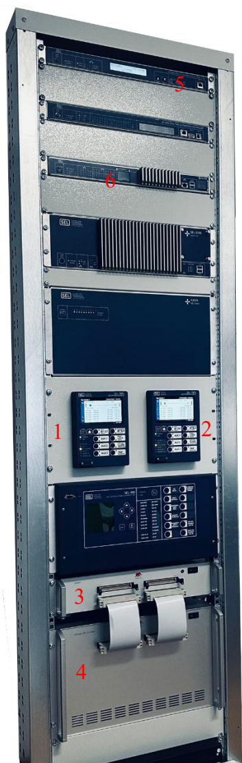
Slika 4: Laboratorijska postavka ispitivanja: 1. SEL-787L zaštitni uređaj - PMU 1, 2. SEL-787L zaštitni uređaj - PMU 2, 3. Typhoon HIL 604, 4. HIL Connect, 5. SEL-2488 GPS sat, 6. SEL-2730 Ethernet svič
